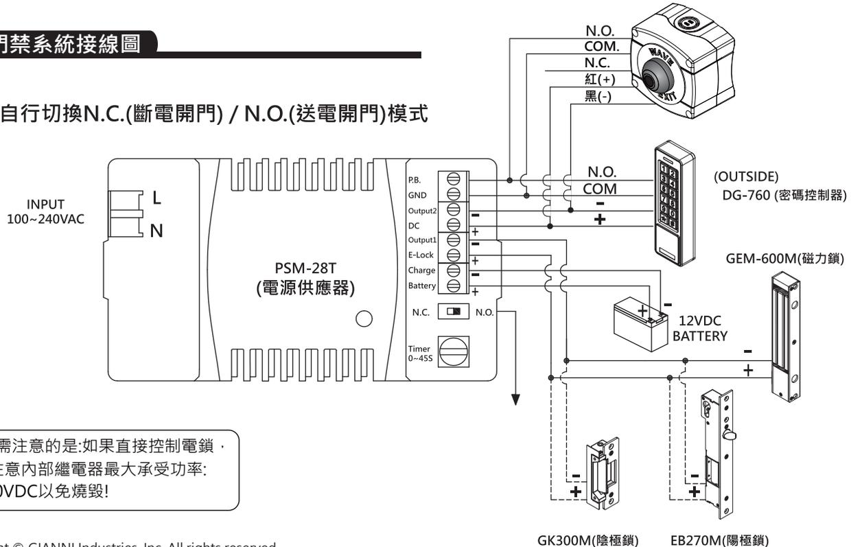
※ 必需注意的是:如果直接控制電鎖，必須注意內部繼電器最大承受功率: 1A/30VDC以免燒毀!
