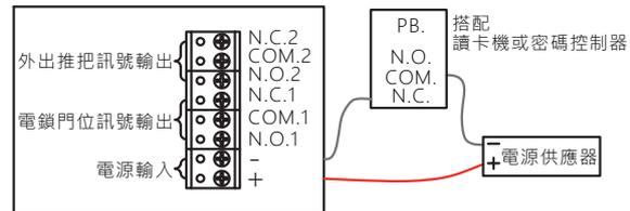
圖B 為使用門禁系統，控制PBH-350系列電鎖接線圖
