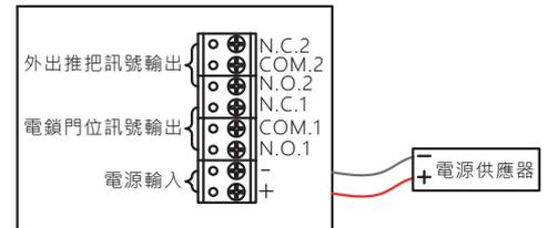
圖A 為PBH-350斷電開門型門鎖接線圖
