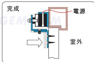
鎖緊Z型輔助架，完成。
