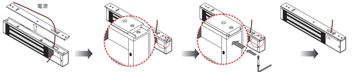
電源線穿過安裝好的特殊邊條以及電磁鎖的接線槽內...
