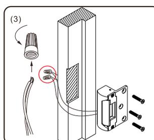
接上電源線，固定陰極鎖，進行測試
