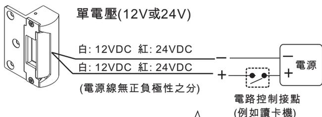
如果設定為「斷電開門型」，則電路控制接點為常閉(N.C.)
