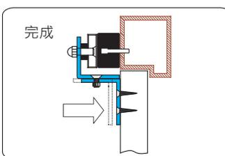
完成 調整Z型輔助架部分頂到門扇。鎖緊Z型輔助架，完成。
