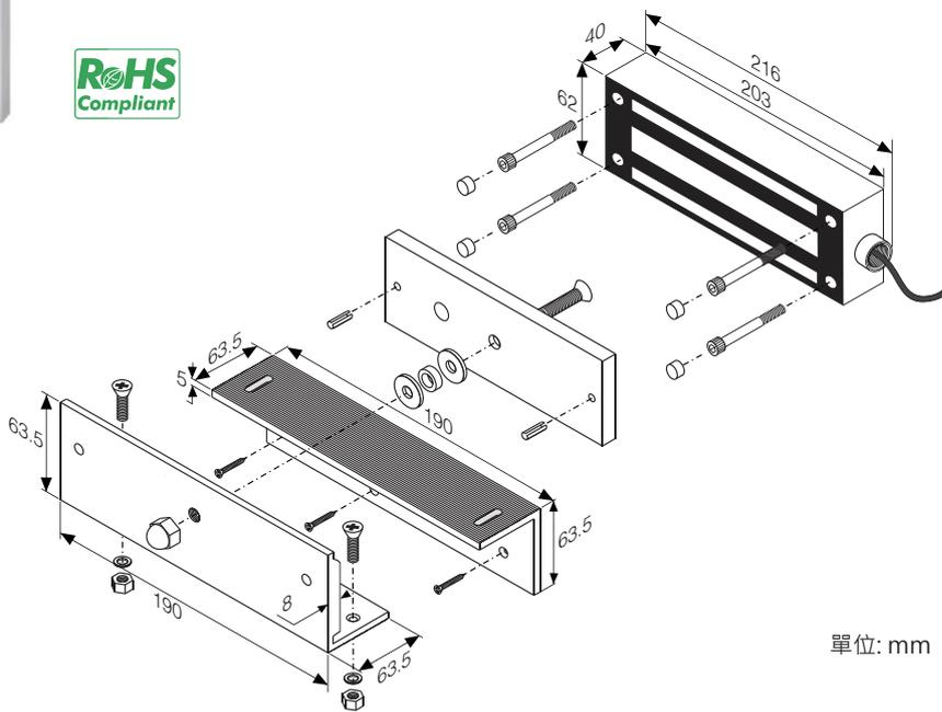
正面孔電磁鎖搭配Z型輔助架安裝於向內開式門
