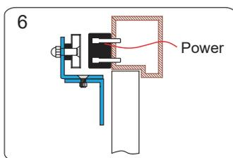
6 吸附板組與電磁鎖正確的吸住後...
