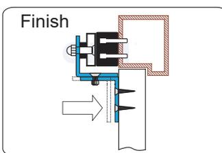
Finish 調整Z型輔助架部分頂到門扇。鎖緊Z型輔助架，完成。
