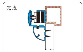
8 鎖緊Z型輔助架，完成。
