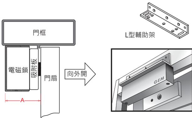
A值表示電磁鎖安裝在門框時所需要的寬度(60mm) · 當門框不足時 · 須加裝L型輔助架。
