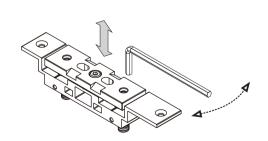
超過剪力鎖最大吸力範圍(2mm)時·可用六角板手調整 吸附板螺絲讓吸附板上升或下降,以調整與剪力鎖的間距。 注意吸附板與電磁鎖的間距必須一致,不可傾斜不對稱。
