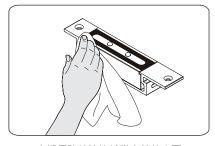
定期用防鏽油擦拭磁力鎖的表面
