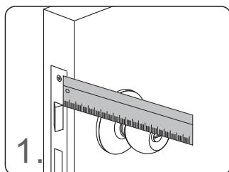
測量機械鎖舌深度及位置距離
