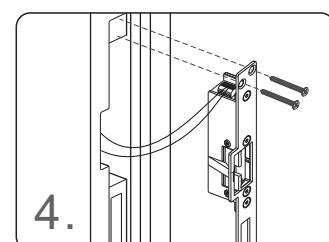
確認接點線路,固定電鎖
