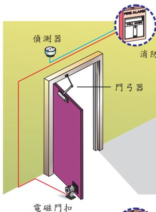
電磁門扣的電源是由消防系統供電 24VDC (12VDC為特殊規格)，平常棟與棟之間的通道防煙門，由電磁門扣吸住呈開門狀態。
