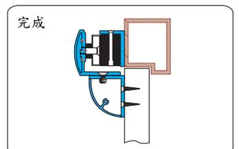
8 鎖緊Z型輔助架，完成。
