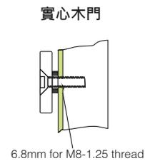
門內先鑽6.8mm孔，金屬板攻M8.1.25mm的螺絲牙。
